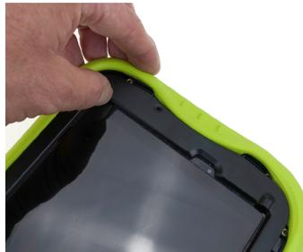
6. Drücken Sie die Hülle ringsherum an das Gehäuse. Sie rastet mit deutlich hörbaren Klickgeräuschen ein.
