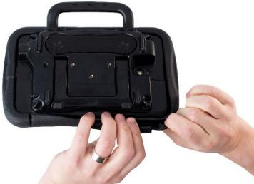
4. Nehmen Sie die neue Hülle und richten Sie sie passend aus. Die 3 Öffnungen an einer der Längsseiten gehören zu den Tasten Ein/Aus, lauter/ leiser sowie der Aktivtaste.
