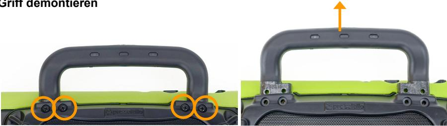
Entfernen Sie die 4 Schrauben, mit denen der Griff am NovaChat 8.5 befestigt ist. Ziehen Sie den Griff nach oben aus dem Gehäuse heraus. Verwahren Sie Griff und Schrauben an einem sicheren Ort.
