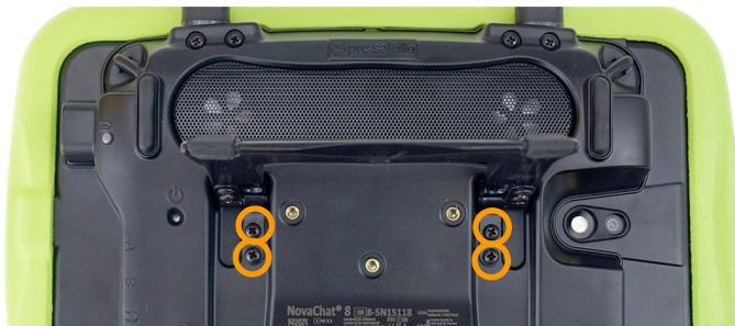
Drehen Sie den NovaChat 8.5 um. Achten Sie darauf, dass das Display dabei nicht verkratzt. Klappen Sie den Ständer hoch. Lösen Sie die 4 Schrauben, mit denen der Ständer am NovaChat 8.5 befestigt ist. Ziehen Sie den Ständer nach oben ab. Verwahren Sie Ständer und Schrauben an einem sicheren Ort.
