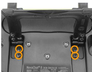
Klappen Sie die beiden Scharniere am Ständer senkrecht auf. Setzen Sie den Ständer in die dafür vorgesehene Aussparung in der Unterseite des NovaChat 8.5 ein und befestigen Sie ihn mit den 4 Schrauben.
