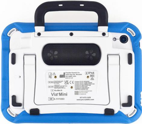
Ziehen Sie den Aufstellfuß bis zum gewünschten Winkel vom Gerät weg. Drehen Sie das Gerät um.
