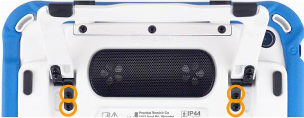
Drehen Sie den Via Mini 8.1 um. Achten Sie darauf, dass das Display dabei nicht verkratzt. Klappen Sie den Aufstellfuß hoch. Lösen Sie die 4 Schrauben, mit denen der Aufstellfuß am Via Mini 8.1 befestigt ist. Heben Sie den Aufstellfuß nach oben ab. Verwahren Sie Aufstellfuß und Schrauben an einem sicheren Ort.
