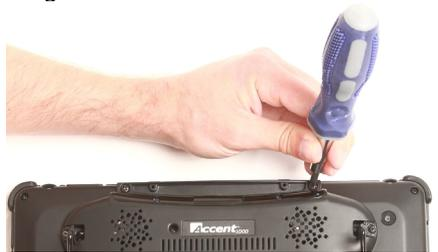
5. Befestigen Sie die Portabdeckung mit den vier Schrauben. **Achtung: Die längeren Schrauben mit Metallgewinde gehören in die äußeren Öffnungen, die kurzen Schrauben in die inneren!**
