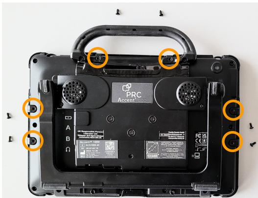
Verschrauben Sie den Rahmen mit den 2 kleineren Schrauben oben durch die kleinen Öffnungen im Griff bzw. in der Portabdeckung bzw. in der Kopfmaus mit dem Gehäuse.
