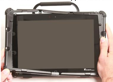
2. Ziehen Sie den Rahmen oben über das Gehäuse, so dass die beiden Zapfen oben am Rahmen in die Aussparungen zwischen Griff und Gehäuse rutschen.
