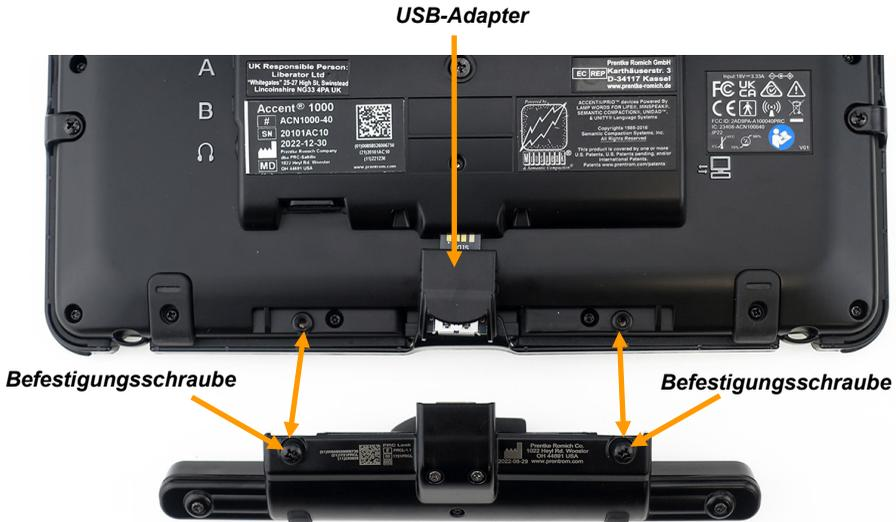
1. Stecken Sie den USB-Adapter in die USB-Buchse unten auf der Rückseite des Accents 1000.
