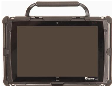
Der Rahmen ist nun montiert. Bei einer Verwendung rein als farbgebendes Element ist keine weitere Befestigung nötig.
