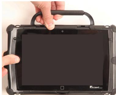
4. Ziehen Sie die beiden Zapfen oben am Rahmen sowie den Zapfen unten aus den Aussparungen nach oben heraus.
