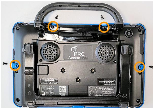
Verschrauben Sie den Rahmen mit 2 Schrauben oben durch die kleinen Öffnungen im Griff bzw. in der Portabdeckung bzw. in der Kopfmaus mit dem Gehäuse. Verschrauben Sie den Rahmen mit 2 Schrauben links und rechts mit dem Gehäuse.
