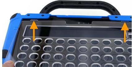
3. Biegen Sie die Fingerführungshilfe leicht horizontal und schieben Sie die beiden oberen Zungen nacheinander in die entsprechenden Aussparungen im Rahmen.
