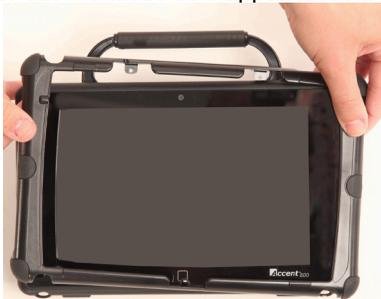
2. Ziehen Sie den Rahmen oben über das Gehäuse, so dass die beiden Zapfen oben am Rahmen in die Aussparungen oben am Griff und Gehäuse rutschen.
