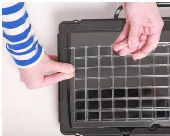
3. Greifen Sie das Fingerführungsgitter oben in der Mitte und biegen Sie es nach oben (vom Display weg).
