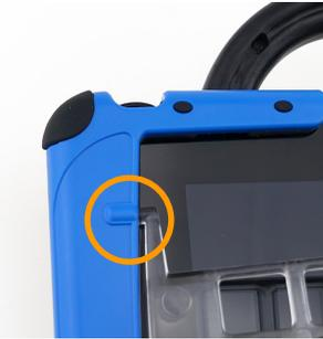
2. Biegen Sie das Fingerführungsgitter und schieben Sie den andern Stift in die gegenüberliegende Aussparung.
