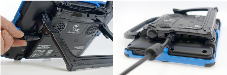
Zum Laden schließen Sie das mitgelieferte Netzteil an die Ladebuchse des Accent 800 an. Sie sollten den Akku laden, wenn die verbleibende Akkukapazität in den kritischen Bereich abgesunken ist. Die Akkukapazität wird sowohl in Empower als auch in NuVoice ständig in der Statuszeile angezeigt. Sie können den Accent 800 beim Laden benutzen.
