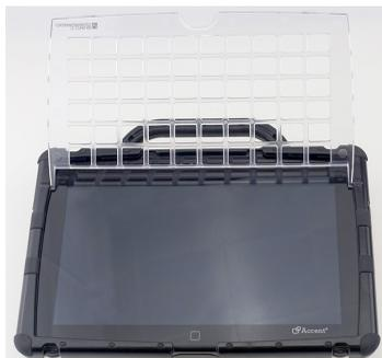
3. Das Fingerführungsgitter verbleibt in der oberen Position, bis Sie es wieder herunterklappen.
