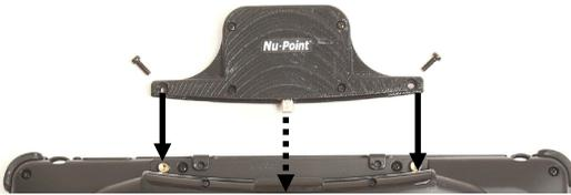
5. Schieben Sie die Kopfmaus in den Accent hinein. Versichern Sie sich, dass der USB-Stecker der Kopfmaus in der USB-Buchse des Accents steckt.
