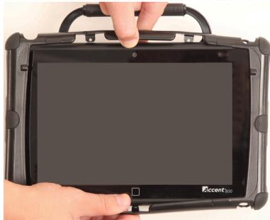
3. Ziehen Sie den Rahmen unten über das Gehäuse, bis der Zapfen hinter das Gehäuse rutscht.
