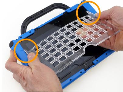
3. Drücken Sie das Fingerführungsgitter unten an (außen links und rechts), bis Sie das Klicken der einrastenden Stege hören.
