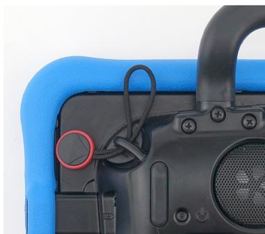
1. Fädeln Sie eine Schlaufe durch eine Öffnung am Gehäuse des NovaChats.
