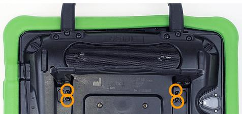
Klappen Sie die beiden Scharniere am Ständer senkrecht auf. Setzen Sie den Ständer in die dafür vorgesehene Aussparung in der Unterseite des NovaChat 10.7 ein und befestigen Sie ihn mit den 4 Schrauben.
