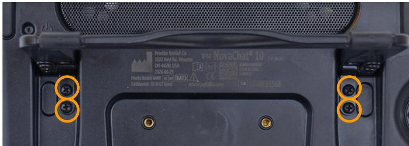
Drehen Sie den NovaChat 10.7 um. Achten Sie darauf, dass das Display dabei nicht verkratzt. Klappen Sie den Ständer hoch. Lösen Sie die 4 Schrauben, mit denen der Ständer am NovaChat 10.7 befestigt ist. Ziehen Sie den Ständer nach oben ab. Verwahren Sie Ständer und Schrauben an einem sicheren Ort.
