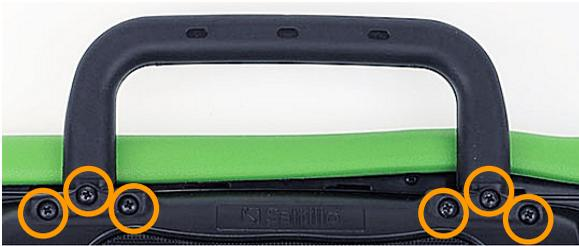
Entfernen Sie die 6 Schrauben, mit denen der Griff am NovaChat 10.7 befestigt ist. Ziehen Sie den Griff nach oben aus dem Gehäuse heraus. Verwahren Sie Griff und Schrauben an einem sicheren Ort.
