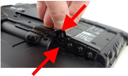
3. Stecken Sie den runden Stecker des Ladegeräts in die Ladebuchse.
