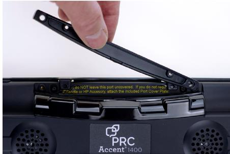
2. Befestigen Sie die Portabdeckung mit den beiden Schrauben.
