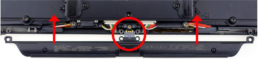
8. Befestigen Sie die Look-Augensteuerung mit den beiden Schrauben der Portabdeckung, die Sie in Schritt 6. entfernt haben, links und rechts vom USB-Stecker am Accent 1400-30.
