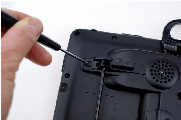
1. Nehmen Sie einen Schraubendreher und entfernen Sie die Schrauben der beiden Bügelhalter.
