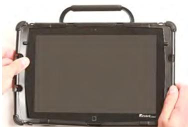
4. Ziehen Sie die beiden Zapfen oben am Rahmen aus den Aussparungen zwischen Griff und Gehäuse nach oben heraus.
