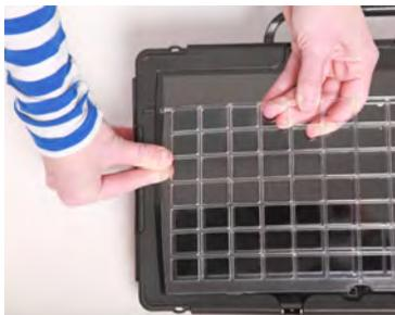
3. Greifen Sie das Fingerführungsgitter oben in der Mitte und biegen Sie es nach oben (vom Display weg).
