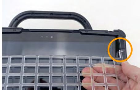
3. Drücken Sie das Fingerführungsgitter unten an (außen links und rechts), bis Sie das Klicken der einrastenden Stege hören.
