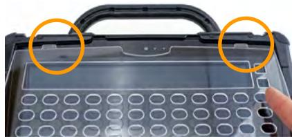
3. Biegen Sie die Fingerführungshilfe leicht horizontal und schieben Sie die beiden unteren Zungen nacheinander in die entsprechenden Aussparungen im Rahmen.
