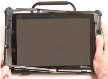
2. Ziehen Sie den Rahmen oben über das Gehäuse, so dass die beiden Zapfen oben am Rahmen in die Ausparungen zwischen Griff und Gehäuse rutschen.
