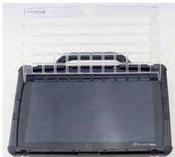
3. Das Fingerführungsgitter verbleibt in der oberen Position, bis Sie es wieder herunterklappen.
