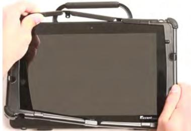
3. Ziehen Sie den Rahmen unten über das Gehäuse, bis der Zapfen hinter das Gehäuse rutscht.
