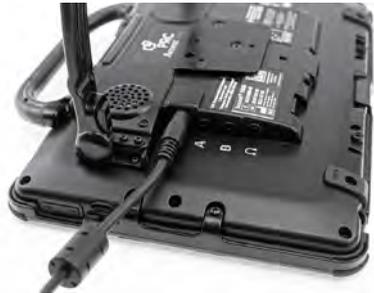
Zum Laden schließen Sie das mitgelieferte Netzteil an die Ladebuchse des Accent 1000 an. Sie sollten den Akku laden, wenn die verbleibende Akkukapazität in den kritischen Bereich abgesunken ist. Die Akkukapazität wird sowohl in Empower als auch in NuVoice ständig in der Statuszeile angezeigt. Sie können den Accent 1000 beim Laden benutzen.
