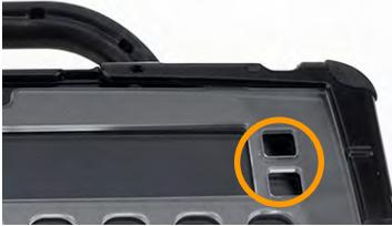
2. Schieben Sie die beiden Zungen oben an der Fingerführungshilfe in die Aussparungen im Rahmen.
