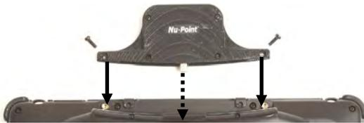
5. Schieben Sie die Kopfmaus in den Accent hinein. Versichern Sie sich, dass der USB-Stecker der Kopfmaus in der USB-Buchse des Accents steckt.
