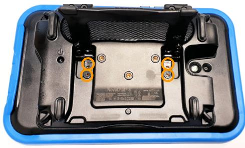
Klappen Sie die beiden Scharniere am Ständer senkrecht auf. Setzen Sie den Ständer in die dafür vorgesehene Aussparung in der Unterseite des NovaChat 8.4 ein und befestigen Sie ihn mit den 4 Schrauben.
