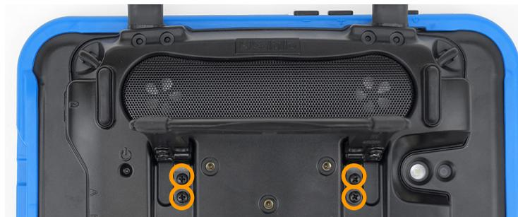
Drehen Sie den NovaChat 8.4 um. Achten Sie darauf, dass das Display dabei nicht verkratzt. Klappen Sie den Ständer hoch. Lösen Sie die 4 Schrauben, mit denen der Ständer am NovaChat 8.4 befestigt ist. Ziehen Sie den Ständer nach oben ab. Verwahren Sie Ständer und Schrauben an einem sicheren Ort.
