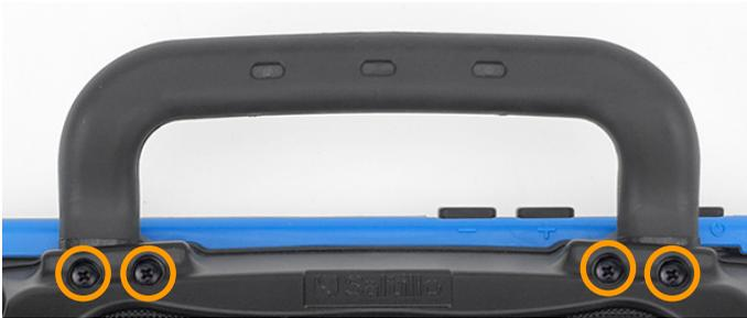
Entfernen Sie die 4 Schrauben, mit denen der Griff am NovaChat 8.4 befestigt ist. Ziehen Sie den Griff nach oben aus dem Gehäuse heraus. Verwahren Sie Griff und Schrauben an einem sicheren Ort.
