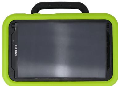
7. Drücken Sie die Hülle ringsherum an das Gehäuse. Sie rastet mit einem deutlich hörbaren Klickgeräusch ein.
