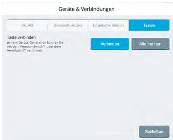
Empower unterstützt die Nutzung von kompatiblen drahtlosen Tasten (Funktasten) wie der AeroSwitch. Funktasten haben den Vorteil, dass sie nicht per Kabel an den Accent angeschlossen werden müssen.
