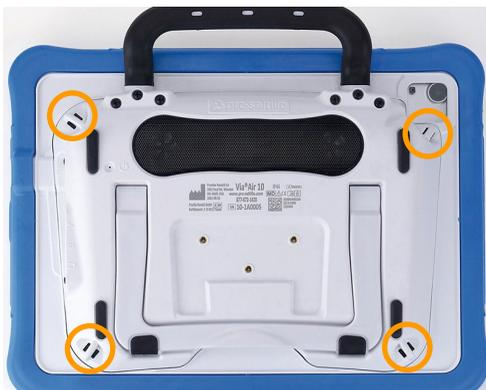
Sie können an den PRIo einen Tragegurt montieren. Zusammen mit dem PRIo haben Sie dazu 2 kleine Schlaufen erhalten. Montieren Sie die Schlaufen an den zugehörigen Ösen (unten bzw. oben bei Benutzung des PRIos im Querformat, links bzw. rechts bei Benutzung des PRIos im Hochformat). Fädeln Sie die Schlaufen wie abgebildet in die Ösen ein.
