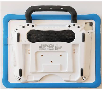
Klappen Sie die beiden Scharniere am Ständer senkrecht auf. Setzen Sie den Ständer in die dafür vorgesehene Aussparung in der Unterseite des PRiO ein und befestigen Sie ihn mit den 4 Schrauben.
