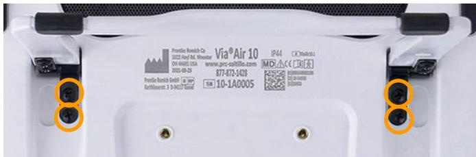
Drehen Sie den PRiO um. Achten Sie darauf, dass das Display dabei nicht verkratzt. Klappen Sie den Ständer hoch. Lösen Sie die 4 Schrauben, mit denen der Ständer am PRiO befestigt ist. Ziehen Sie den Ständer nach oben ab. Verwahren Sie Ständer und Schrauben an einem sicheren Ort.
