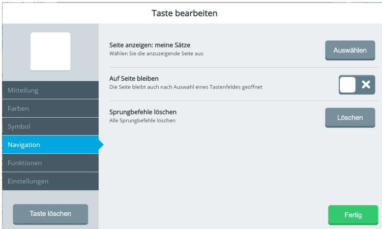
**Auf Seite bleiben:** schalten Sie diese Option ein, damit die Seite dauerhaft geöffnet bleibt. Ist diese Option nicht eingeschaltet, springt Empower nach der Auswahl eines Feldes wieder zurück zur vorherigen Seite. Auf der anzuzeigenden Seite muss mindestens ein Tastenfeld mit einer Sprungtaste („Zurück“, „Start“, „Seite anzeigen“ etc.) belegt sein, damit sie die Seite wieder verlassen können.
