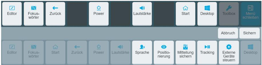
In der oberen Reihe sehen Sie die aktuell angebotenen Schnellbefehle. Dunkle leere Felder können noch belegt werden. In der unteren Reihe sehen Sie die zur Verfügung stehenden Schnellbefehle. Die ausgegrauten sind bereits in der Schnellbefehlleiste vorhanden.
