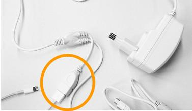
Schließen Sie das mitgelieferte weiße USB-Kabel zum Laden des PRiOs an die Kupplung im Ladekabel des PRiO-Netzteils an.
