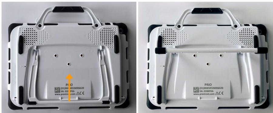
Ziehen Sie den Bügel nach oben. Drücken Sie den Bügel in die obere Arretierung. Drehen Sie das Gerät um.
