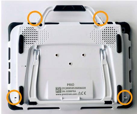
Sie können an den PRIO einen Schultergurt montieren. Zusammen mit dem PRIO haben Sie dazu 2 kleine Schlaufen erhalten. Montieren Sie die Schlaufen an den zugehörigen Ösen (unten bzw. oben bei Benutzung des PRIOs im Querformat, links bzw. rechts bei Benutzung des PRIOs im Hochformat). Fädeln Sie die Schlaufen wie abgebildet in die Ösen ein.
