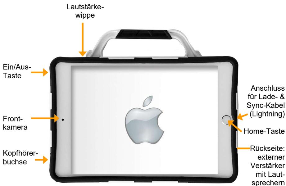
Die **Ein-/Aus-Taste** oben links auf dem PRiO dient zum Aufwecken des Geräts aus dem Standby (kurzer Druck) und zum Ein- und Ausschalten des PRiOs (einige Sekunden gedrückt halten).
