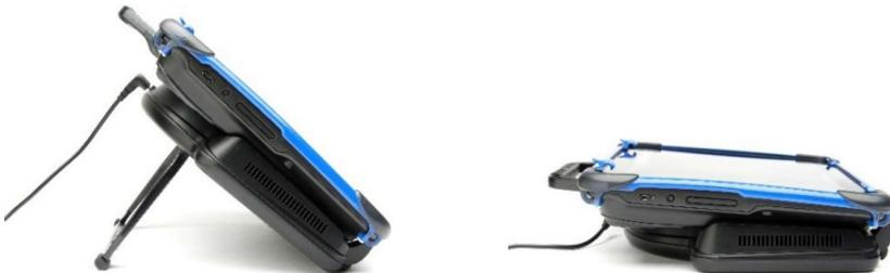
Legen Sie den ChatFusion in die Ladestation. Die Ladekontrollleuchte in der Ladestation leuchtet blau, wenn der ChatFusion drahtlos geladen wird. Die Ladekontrollleuchte auf dem ChatFusion leuchtet während des Ladevorgangs rot. Ist der Akku vollständig geladen, wechselt die Farbe auf blau.
