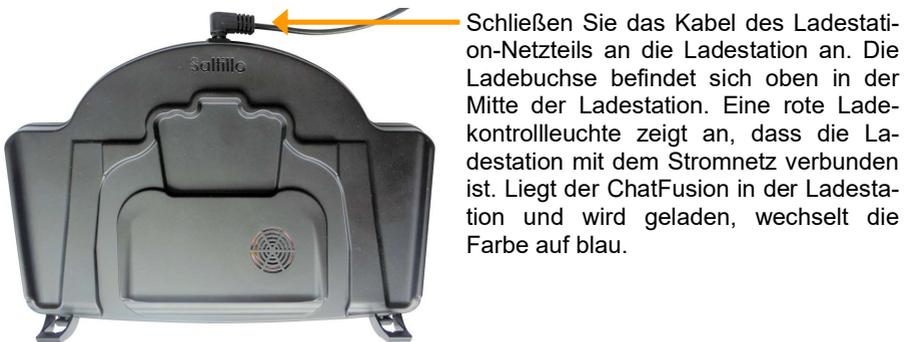
Wenn Sie den ChatFusion beim Laden in der Ladestation benutzen wollen, so klappen Sie den Aufstellbügel der Ladestation aus. Der Bügel ermöglicht eine Nutzung des ChatFusion in der Ladestation in einem Winkel von ca. 45°.
