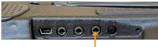
Wenn Sie auditives Scanning (Ansagescanning) verwenden, schließen Sie den Kopfhörer an die Kopfhörerbuchse an der rechten Seite des Verstärkers an.
