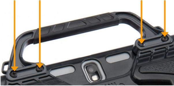
Zum Montieren des Tragegriffs gehen Sie in umgekehrter Reihenfolge vor.
