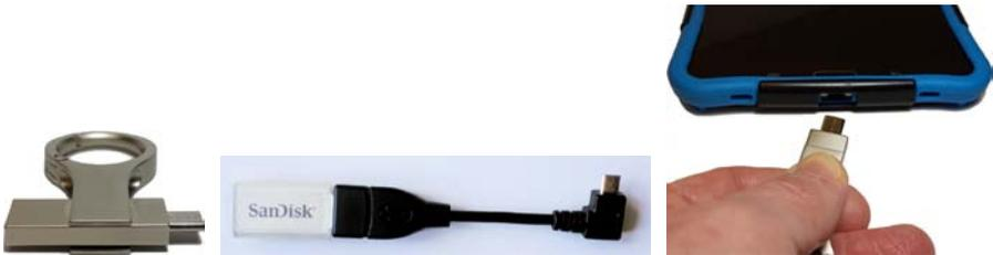
Zusammen mit dem NovaChat haben Sie einen USB-Stick mit je einem Standard- und einem Micro-USB-Stecker erhalten (linke Abb.). Alternativ können Sie jeden beliebigen USB-Stick mittels USB-auf-Micro-USB-Adapter bzw. USB-auf-USB-C-Adapter verwenden (mittlere Abb.). Legen Sie auf dem USB-Stick einen Ordner z. B. namens „NC-Backup“ an. Schließen Sie den USB-Stick an den NovaChat an (rechte Abb.).
