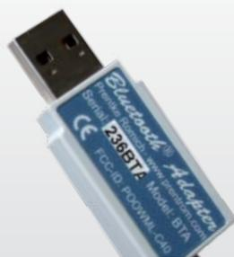
Der PRD Bluetooth-Adapter ermöglicht PRD-Talkern mit Bluetooth-Funktionalität (Accent- sowie Vorgängergeräte) die kabellose Steuerung eines PCs. Der Adapter wird einfach in eine USB-Buchse des zu steuernden PCs gesteckt und mit dem Talker gekoppelt. Die Übertragung erfolgt per Funk über eine Entfernung von bis zu mehreren Metern.
