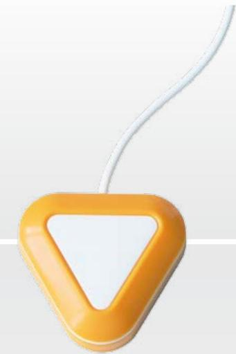
Candy Corn ist eine Sensortaste, die rein auf Annäherung reagiert und keinen Körperkontakt zum Auslösen benötigt. Eine Annäherung auf 10 mm über der Taste mit irgendeinem Körperteil genügt für das Auslösen, das durch ein Lichtsignal sowie einen Piepton bestätigt wird. Die Taste ist dreieckig mit einer Kantenlänge von ca. 5 cm. Ein Ausschalter ist auf der Unterseite angebracht. Der Betrieb erfolgt mit einer Batterie vom Typ CR-2032.
