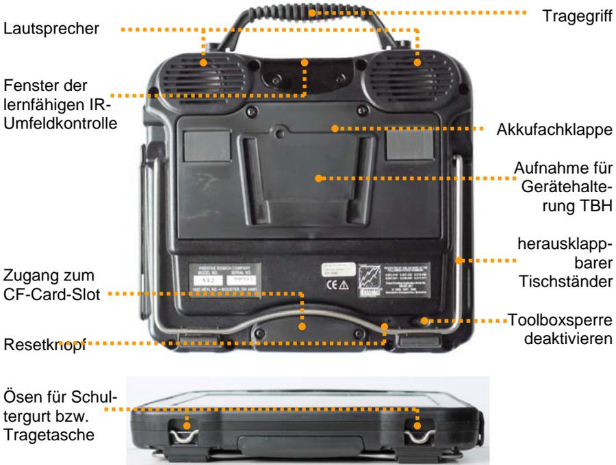
**Lautsprechergitter:** Hinter den 2 ovalen Öffnungen befinden sich die 2 Lautsprecher des SmallTalkers. Für optimale Lautstärke und Klarheit sollte dieser Bereich nicht abgedeckt werden.
