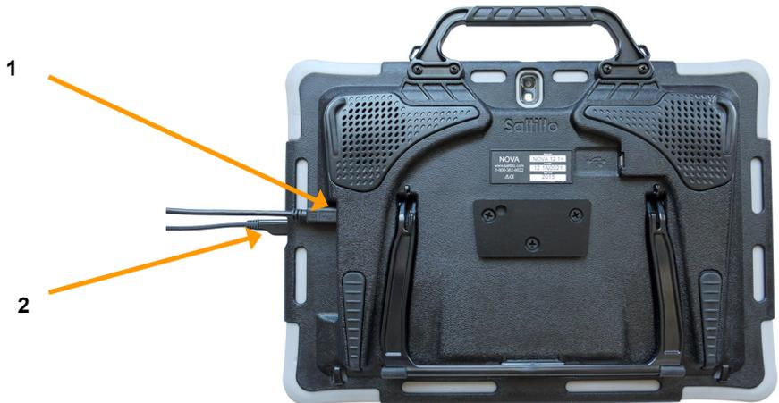
Das Tablet verfügt über einen USB 3.0 Micro B Anschluss:
