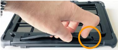
Biegen Sie den Verriegelungssteg soweit, dass das andere Ende in der zugehörige Aussparung des Fingerführungsgitters einrastet.
