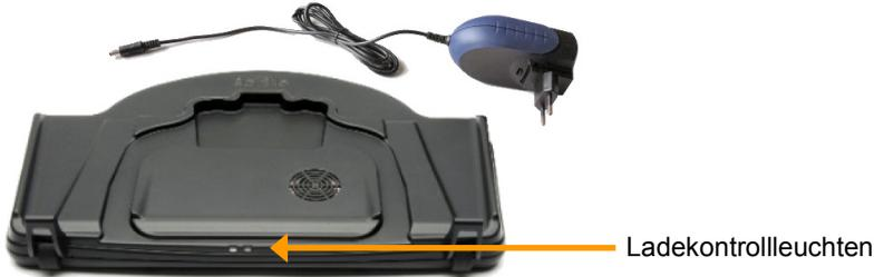
Stellen Sie die Ladestation zum Laden des ChatFusion auf eine ebene Oberfläche. Achten Sie darauf, dass sich die Ladestation an einem Ort mit guter Durchlüftung befindet, so dass die entstehende Wärme abgeführt werden kann.
