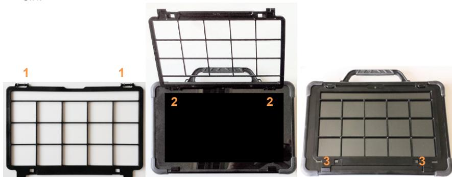
Die unten im Display sichtbare Menüleiste
