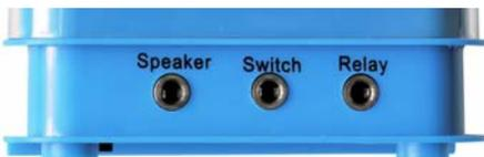
Der Sound-Shuffle verfügt über 3 seitlich angebrachte Buchsen.
