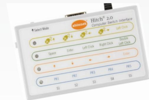
Hitch ist der Tastenadapter der Firma AbleNet. Er ermöglicht den Anschluss von bis zu 5 Tasten an Computer mit USB-Anschluss. Zur Nutzung verschiedener Programme gibt es 5 verschiedene Belegungen, die per Knopfdruck umgeschaltet werden (siehe Tabelle). Eine farbige LED signalisiert die gerade aktuelle
