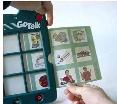
1. Entfernen Sie das Deckblatt (mit der Kunststoffhülle) aus dem GoTalk, indem Sie die Kunststoffhülle nach rechts herausziehen.
