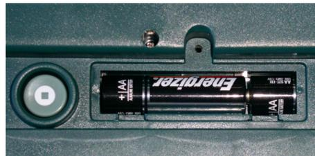
Entnehmen Sie die alten Batterien und legen Sie die neuen ein. **Achten Sie auf die richtige Polung!** Die Polung ist im Boden des Batteriefachs eingraviert. Die Pluspole zeigen jeweils nach links in Richtung des Ein/Aus-Schalters.
