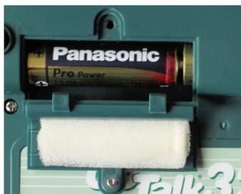
Entnehmen Sie die alten Batterien und legen Sie die neuen ein. **Achten Sie auf die richtige Polung!** Die Polung ist im Boden des Batteriefachs eingraviert. Die Pluspole zeigen jeweils nach links. Setzen Sie die Batteriefachklappe wieder ein und schließen Sie sie mit Hilfe der Kreuzschraube.
