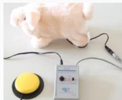
9. Schließen Sie eine Taste an den SLAT an und wählen Sie eine Betriebsart. Das Schwein ist einsatzbereit!
