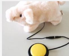
7. Schließen Sie eine Taste an den Batterieunterbrecher an. Solange die Taste gedrückt wird, wird das Schwein laufen!
