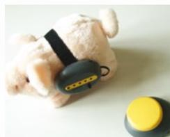
10. Statt einer einfachen Taste können Sie auch die Funktaste JellyBeamer mit eingebautem SLAT verwenden. Wenn sich das Tier „verlaufen“ hat, kann man sich bei der Suche am Geräusch orientieren.
