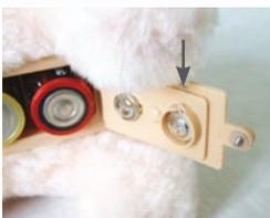
5. Um ein Abklemmen und Brechen des Batterieunterbrecherkabels zu vermeiden, wird eine Aussparung in die Klappe des Batterie-faches gefeilt.
