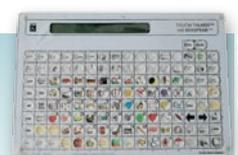
Mit Touch- und LightTalker erscheinen die ersten vollintegrierten Kommunikationshilfen mit synthetischer deutscher Stimme. Der TouchTalker hat 128 Tasten für Direktselektierer, der LightTalker kann per Scanning oder berührunglos mittels eines kleinen optischen Sensors angesteuert werden.
