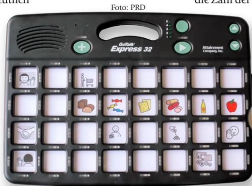
steuerung im 1- und 2-Tasten-Scanning. Der *GoTalk Express 32* bietet eine Vielzahl von Scanoptionen (Zeile/Spalte, linear, kreisförmig, Block) bei 3 Scangeschwindigkeiten (2 Sek., 3 Sek. und 5 Sek.). Im Scanbetrieb kann die Zahl der Tastenfelder auf 4, 8
