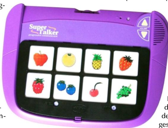
Der SuperTalker verfügt in der Standardversion über einen Speicher von 8 Minuten. Die leistungsfähigere Version
